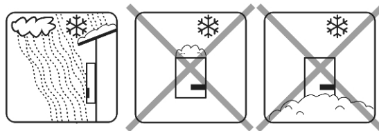
Abbildung 2.4 Ausreichende Luftströmung sicherstellen
